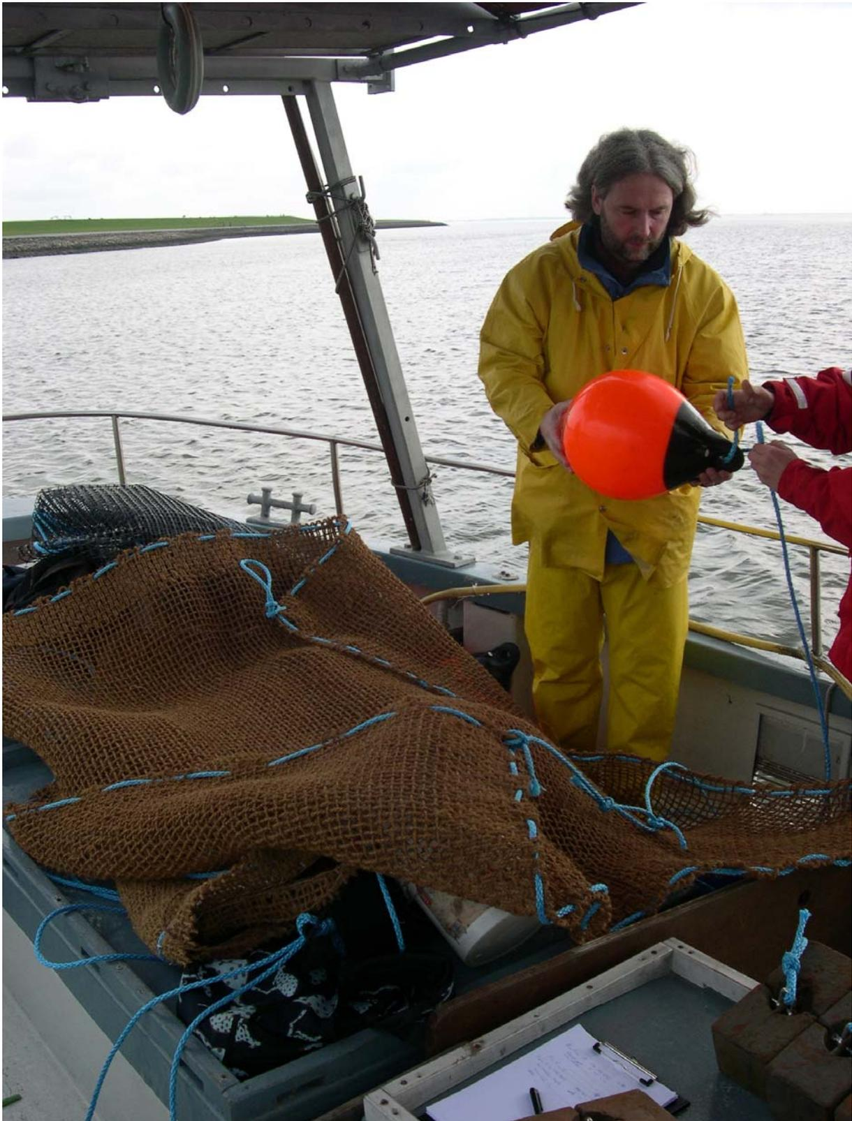
Befestigung des Auftriebskörpers am Kollektor
